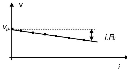
La expresión analítica reproduce ahora los resultados del experimento. Entonces hemos encontrado un MODELO que describe el comportamiento de nuestra batería, en términos de un *GENERADOR DE TENSIÓN IDEAL* (que cumple con la definición) y de un elemento pasivo,  $R_i$ , que se incorpora como un elemento más al circuito.
