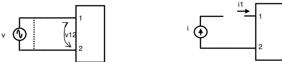
En resumen: un generador ideal de tensión se pasiva poniendo sus terminales en cortocircuito y un generador de corriente ideal dejando sus terminales en circuito abierto. Las correspondientes resistencias internas de los generadores reales pasaron a formar parte del resto del circuito.
