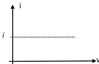
Para comprender el sentido de estas definiciones es necesario estudiar el comportamiento del circuito correspondiente al generador de tensión mostrado arriba. Para ello utilizaremos alguna fuente de energía disponible, por ejemplo una batería de 9 volts y una resistencia variable de valor adecuado.
