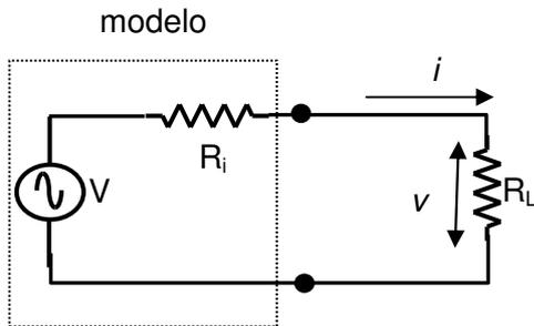
$$v = i \cdot R_L = \frac{V}{R_i + R_L} \cdot R_L \quad (1)$$
