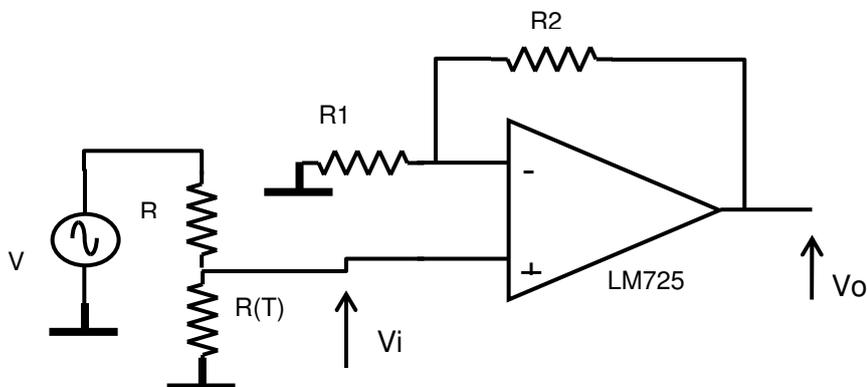
El circuito corresponde esquemáticamente al un medidor de temperatura, donde:
